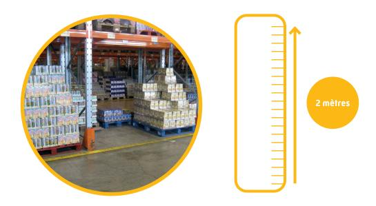
Pour les références à faibles rotations, lorsqu'elles sont conditionnées sur des palettes de hauteur intermédiaire (aux environs d'1,10 m), il est recommandé d'effectuer la prise d'articles, produits ou colis à plus de 40 cm du sol, afin de réduire les flexions du tronc. Cet objectif peut être atteint en utilisant des réhausses.
