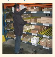
Le stockage des articles, produits ou colis dans des étagères inclinées, munies de galets, permet un prélèvement en façade. Par ailleurs, facilement insérables sous les palettiers, ces équipements permettent de multiplier par deux voire par trois, le nombre de références au mètre linéaire.
